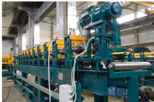
В базовую комплектацию линии входят ножницы с фигурными ножами на один вид реза. Возможна установка в линию ножниц в сборе (или сменных блоков фигурных ножей на существующие ножницы) для других видов реза.
