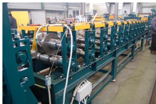
Настройка стана на другой размер профиля производится заменой проставочных втулок между роликами на каждом валу. Тем самым, увеличивается или уменьшается ширина полок профиля.
