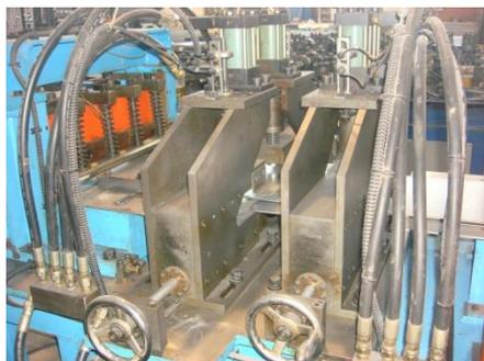
8 - гидростанция для отрезной машины, разгружающего конвейера.
