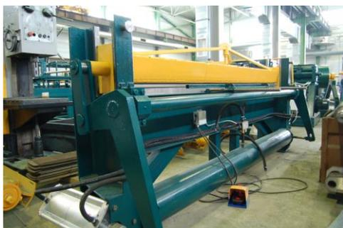
Гибочный станок с пневматическим приводом ЛГСП-27 создан для производства деталей из тонколистового металла толщиной до 1,2мм в заводских условиях.
