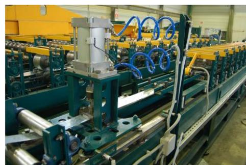
**Линия для производства профилей ПП60x27 и ПНП28x27 производительностью 150 п.м./мин:**
